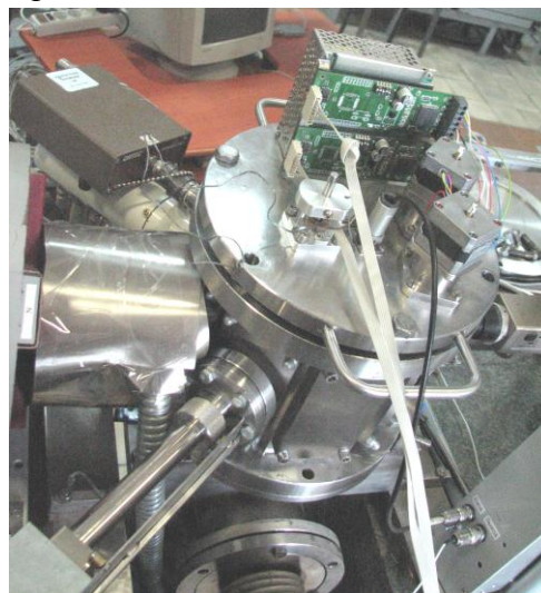
Рис. 7. Камера взаємодії сфокусованого пучка з мішенями
