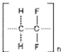
Рис. 1. Структурна формула фторопласту-2 (полівінілденфторид ПВДФ)
